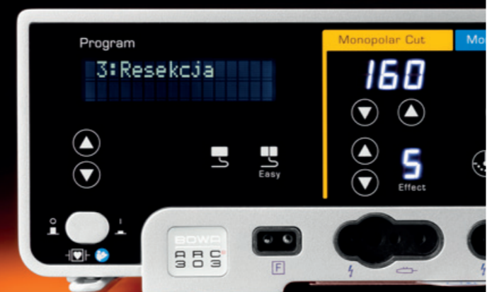
Program resekcji umożliwia zastosowanie 300 W do waporyzacji za pomocą monopolarnych resektoskopów
