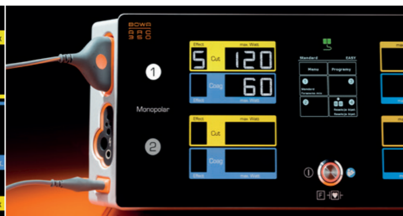
Plug & Cut: ARC 350 rozpoznaje automatycznie, że zostało podłączone standardowe narzędzie
