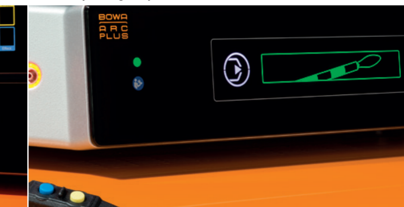
Zielony wskaźnik sygnalizuje wstępne płukanie argonem podłączonych instrumentów
